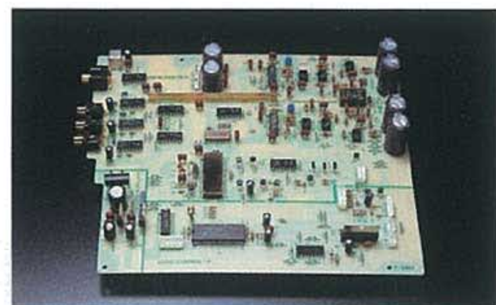
オーディオ信号を大切に設計した基板設計。AWD、AWFなど最新デバイスを使用したアナログ基板。
