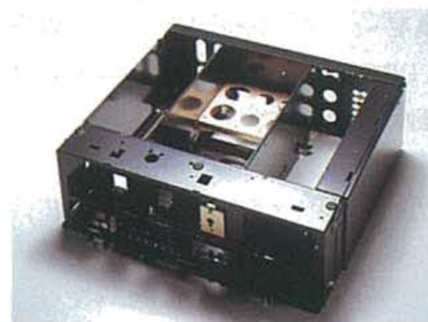
シールド特性を向上させた無振動、無共振設計の高剛性ソリッド&アンチフラックス・シャーシ。
